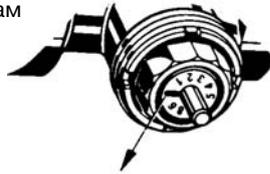
Бороздка для отвертки для проведения регулировки настроечного винта
